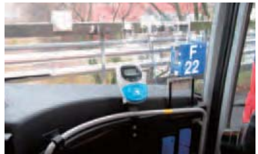
写真23-2 「電子決済機器」 乗降口付近に設置されている
