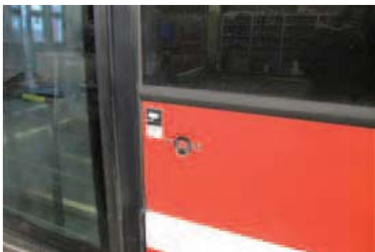
写真2-1 「乗降口のカメラ設置表示と呼び出しボタン（Busslink社）」 ベビーカーや手押し車を押して乗車する乗客は、押しボタンを押して運転手に知らせることができる。 乗降口がフラットで広く、乗り降りがしやすい。
