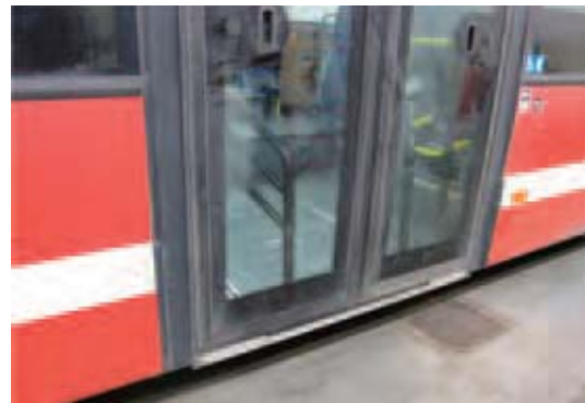
写真16-1 「Busslink社の車両中央乗降口」 通常の状態でもかなりステップ が低い
