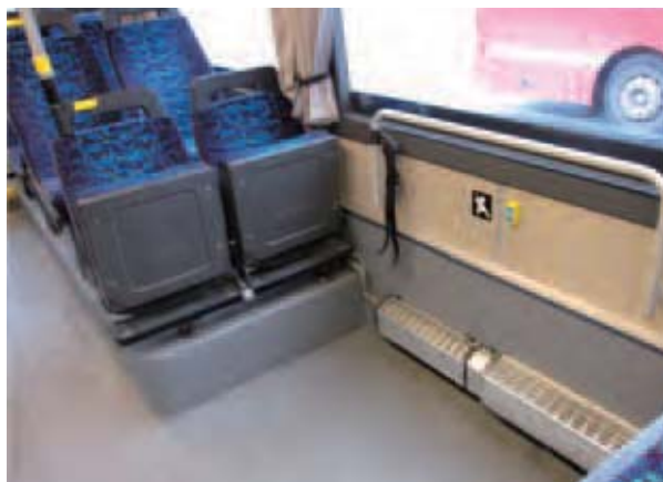
写真18-3 「Busslink社連結車両内部のベビー カースペース」 固定用のベルトもある
