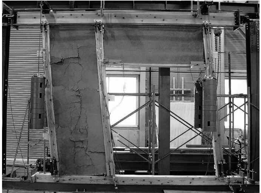
▲本学構造実験棟での「木造土塗り壁の実大加力」実験の様子
