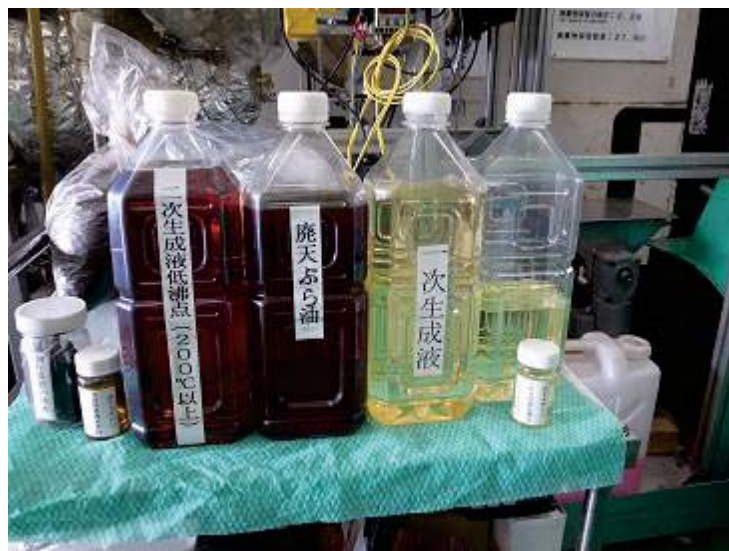
発泡スチロール油化装置で作られたスチレン油（右から2番目）
